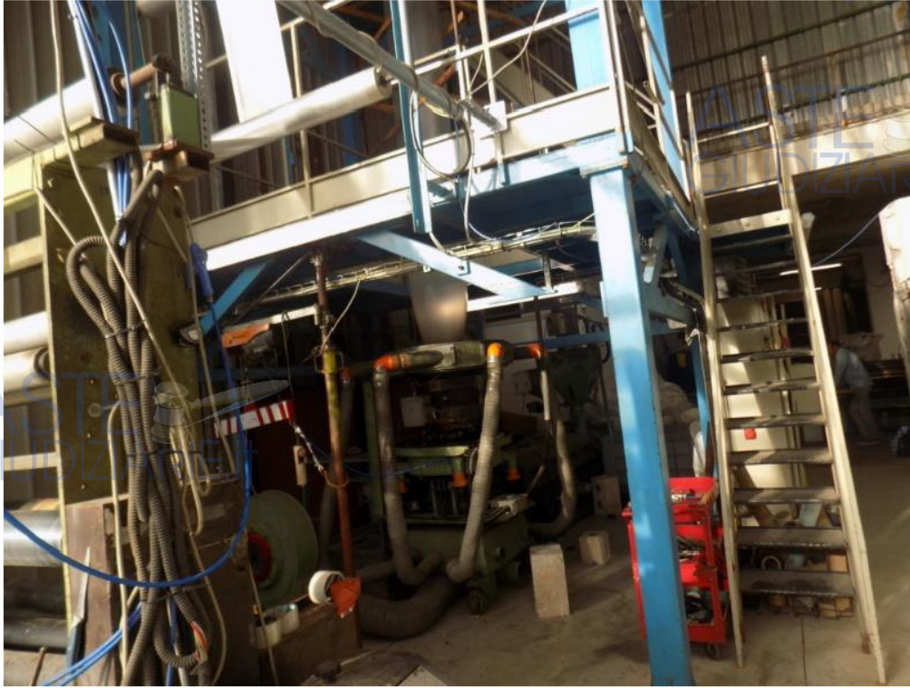
Foto 7 e 8: Interni della struttura realizzata in ampliamento che ospita un estrusore per materie plastiche alto circa 8,00 m e pertanto fuori sagoma rispetto alla volumetria originaria del deposito in muratura.
