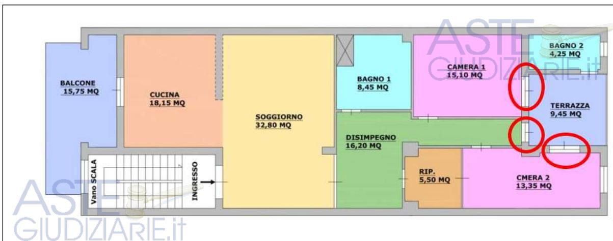
**Figura n.2-** Planimetria stato di fatto dove si evince la diversa distribuzione degli spazi interni (realizzazione del disimpegno e conseguente mutamento dei vani); la realizzazione e spostamento delle porte finestre poste sul lato Sud (cerchiate in rosso)
