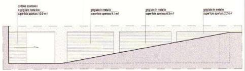
SEZIONE RAMPA CARRABILE CORPO D - scala 1:100
