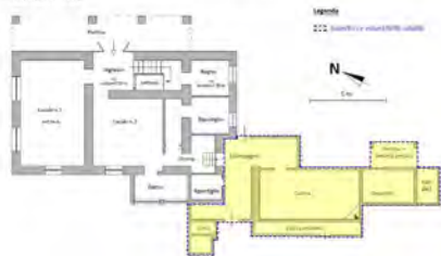
Figura 13 - Planimetria dell'attuale stato dei luoghi - Piano Terra (in giallo le parti non censibili)
