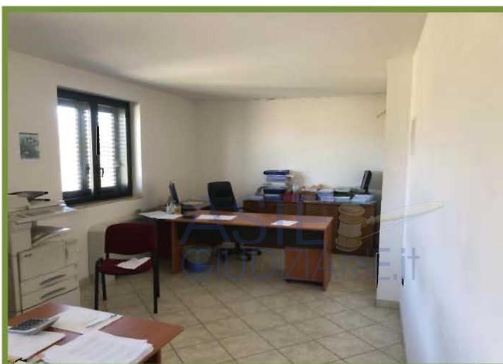
locali destinati ad uffici non hanno i requisiti minimi di abitabilità in quanto l'altezza minima risulta inferiore a mt. 2.70.
