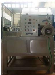
Pressa automatica continua in acciaio inox per la produzione di paste corte, lunga e sfoglia con il cambio delle trafilè.
