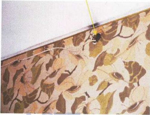
Derivazioni bruciate per corto circuiti
