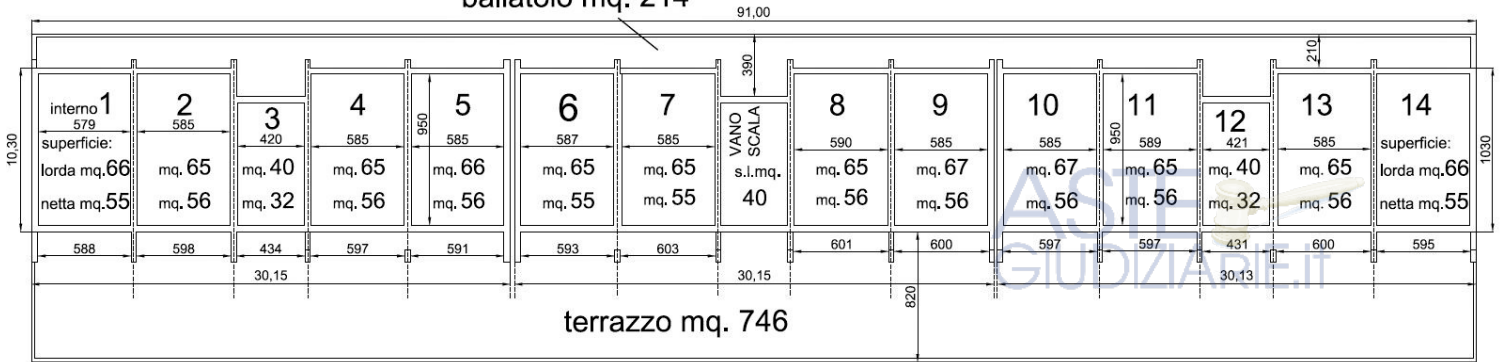
PIANTA PIANO TERRA Edificio C1
