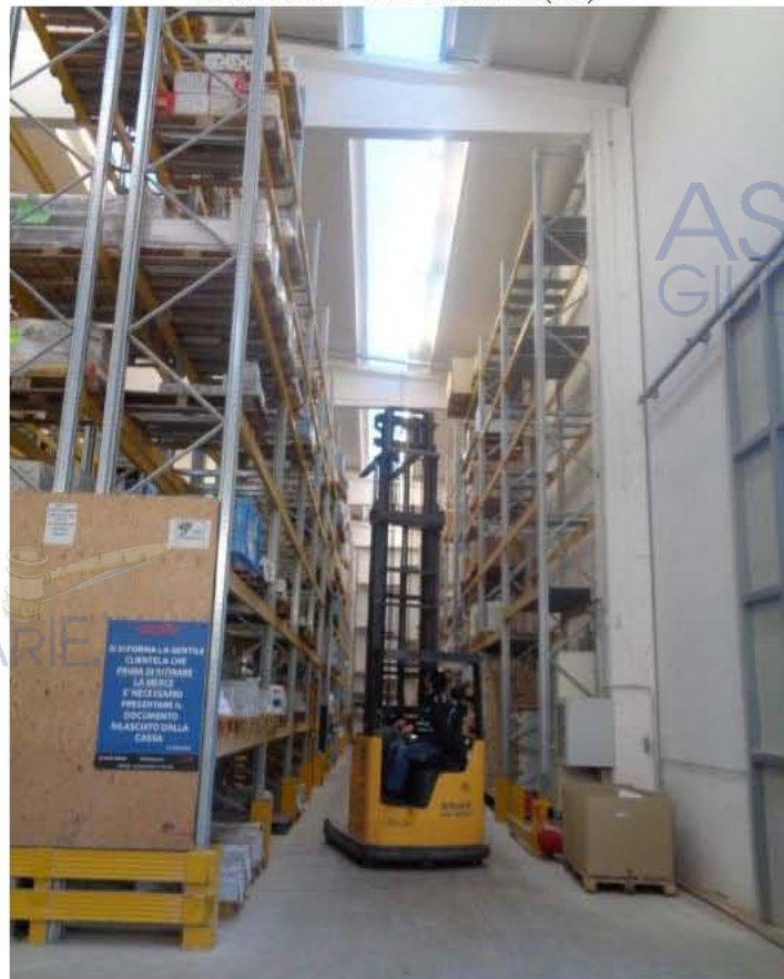
Carrello elevatore marca Atlet Mod. UHT272
