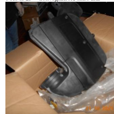
Foto n. 23 – Convogliatore filtro aria
