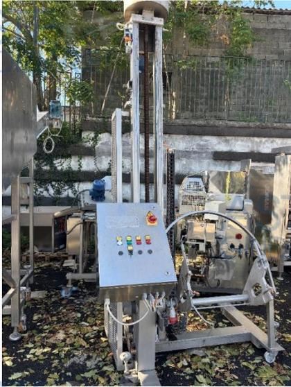
Il macchinario in oggetto è un elevatore per vasca impastatrice che può trasportare, sollevare ad altezza desiderata ed infine rovesciare in modo parziale o completo, il contenuto presente nelle vasche ad esempio delle planetarie ed è un componente di una intera linea di produzione e dunque dovrebbe essere connesso ad altre attrezzature per la lavorazione alimentare automatizzata per cui il bene non può essere utilizzato in modo autonomo.
