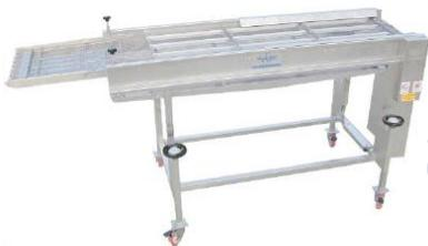
**Trasportatore in rete** realizzato per l'alimentazione di macchine per trattamenti successivi come l'infarinatura, la pastellatura, la panatura, surgelazione, ecc. Costruito completamente in acciaio inox Aisi 304 e materiali plastici in uso nell'industria alimentare, di facile lavaggio e sanificazione.
