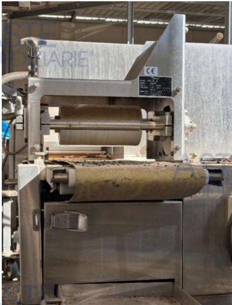
Il macchinario in oggetto è un componente di una intera linea di produzione e dunque connesso ad altre attrezzature per la lavorazione alimentare automatizzata. E' un rullo che serve ad abbassare l'altezza dei prodotti che escono dalla **Formatrice Cornucopia modello:KN400**.
