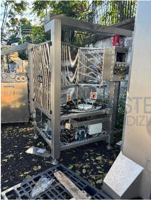
Il macchinario è progettato per l'accumulo del prodotto ed è un componente di una intera linea di produzione e dunque connesso ad altre attrezzature per la lavorazione alimentare automatizzata per cui il bene non può essere utilizzato in modo autonomo.
