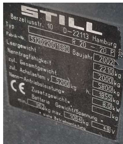
Foto 105- Carrello Elevatore (muletto) elettrico – Portata 2000 kg Foto 106- Etichetta Elevatore (muletto)
