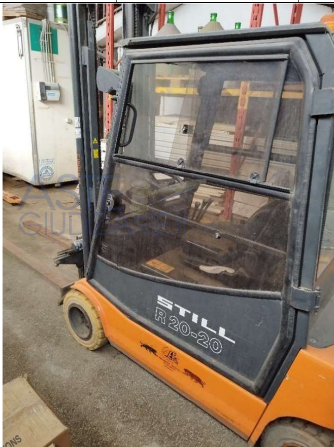
Foto 105- Carrello Elevatore (muletto) elettrico – Portata 2000 kg Foto 106- Etichetta Elevatore (muletto)
