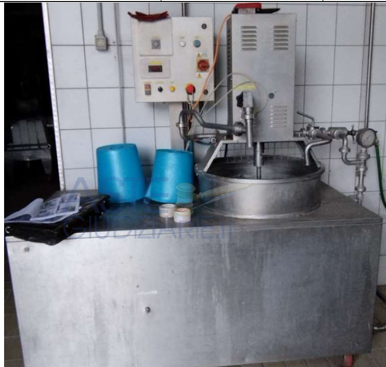
Foto 8 - Lisciatrice omogeneizzatore per ricotta
